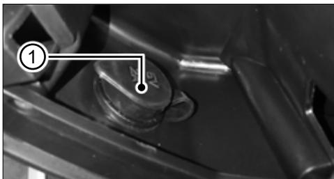
Die USB-Steckdose **1** befindet sich im linken Handschuhfach. Diese Steckdose kann Geräte mit geringem Stromverbrauch bei laufendem Motor laden.
