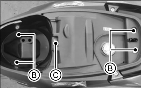
Die 4 Schrauben **B** entfernen und das Helmfach herausnehmen. Den Steckverbinder der Wegfahrsperre **C** trennen.
