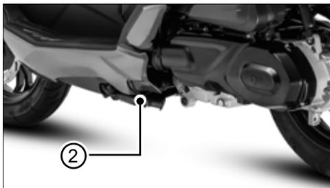
Der Seitenständer **2** ist mit einem Schalter ausgestattet. Der Motor kann nicht gestartet werden.
