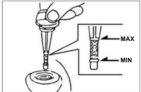
Ölstand an oder unter der **MIN**-Markierung:
