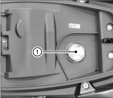
Die Sitzbank öffnen (siehe [Seite 18](#)). Den Tankdeckel **1** gegen den Uhrzeigersinn drehen. Die Zapfpistole einsetzen und den Tank bis zum Sicherheitsventil volltanken.
