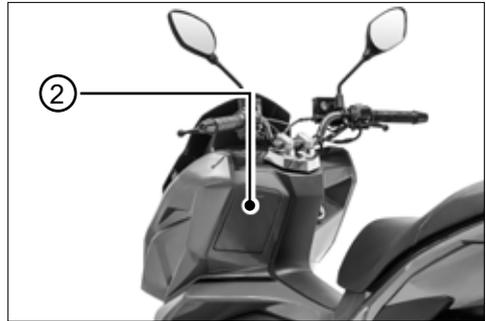
Das vordere Handschuhfach befindet sich links neben dem Zündschalter. Das Fach **2** kann durch drücken auf die Klappe geöffnet werden.
