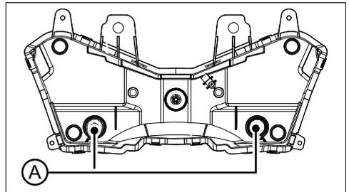
Die Schrauben **A** auf der Rückseite des Scheinwerfers drehen, um die Leuchtweite des jeweiligen Scheinwerfers einzustellen.
