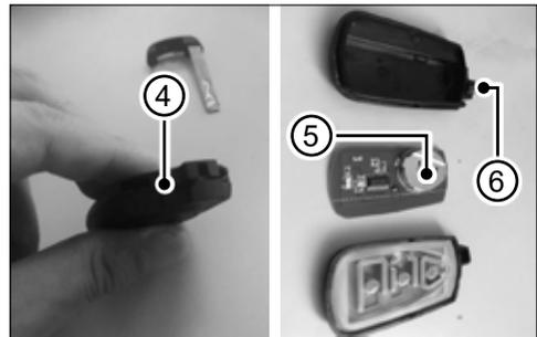
Das Gehäuse vorsichtig mit einem Schitzschraubendreher am Punkt **4** öffnen.
