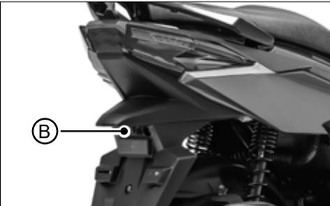
Die Kennzeichenbeleuchtung **B** demontieren.
