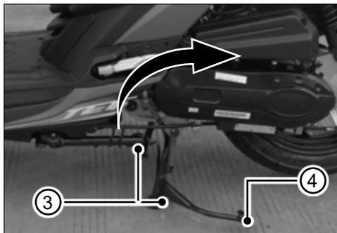
Den Motorroller gerade stellen. Den Lenker und den Soziushaltegriff festhalten. Die beiden Ausleger **3** des Hauptständers gleichmäßig auf den Boden drücken. Mit dem Fuß auf den Ausleger **4** drücken und den Motorroller nach oben/hinten ziehen.
