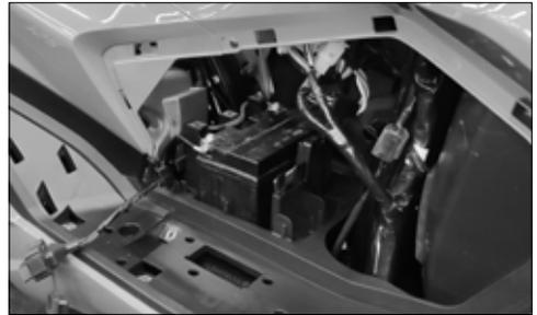
Zuerst das Minuskabel, anschließend das Pluskabel trennen und die Batterie aus dem Batteriefach herausziehen.
