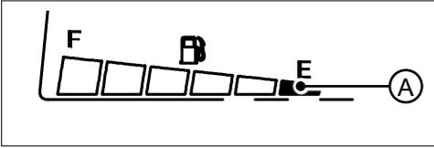
Die Anzeige zeigt den Füllstand des Kraftstofftanks an.
