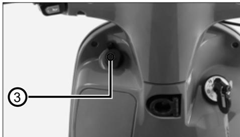
Die USB-Steckdose **3** befindet sich auf der linken Seite über den Tankdeckel. Diese Steckdose kann Geräte mit geringem Stromverbrauch bei laufendem Motor laden.
