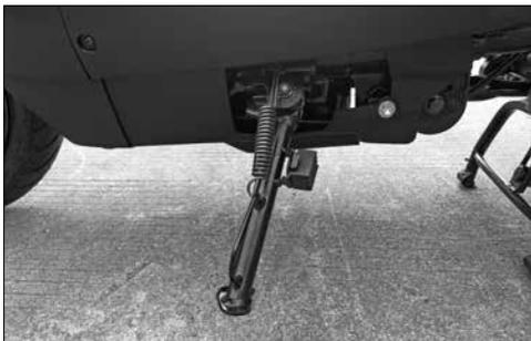
Der Seitenständer ist mit einem Schalter ausgestattet. Bei eingeschalteter Zündung und ausgeklapptem Seitenständer kann der Motor nicht gestartet werden.
