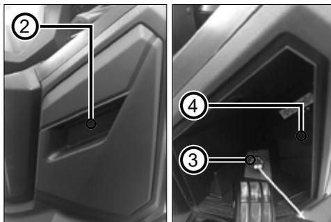
Das vordere Handschuhfach befindet sich neben dem Zündschalter. Das Fach durch ziehen am Griff **2** öffnen. Die USB-Steckdose **3** und die 12V-Steckdose **4** befindet sich in diesem Fach. Diese Steckdosen können Geräte mit geringem Stromverbrauch bei laufendem Motor laden.
