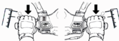
Bremshebelspiel der Trommelbremse
