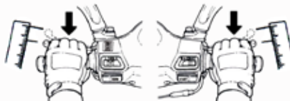
Bremshebelspiel der Trommelbremse
